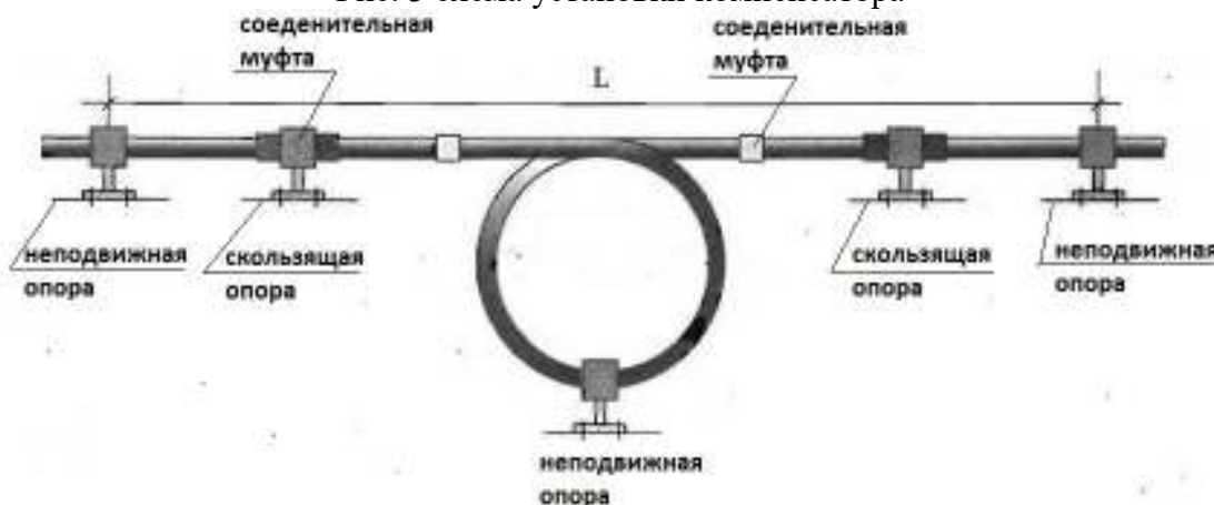
Рис. 3 схема установки компенсатора
